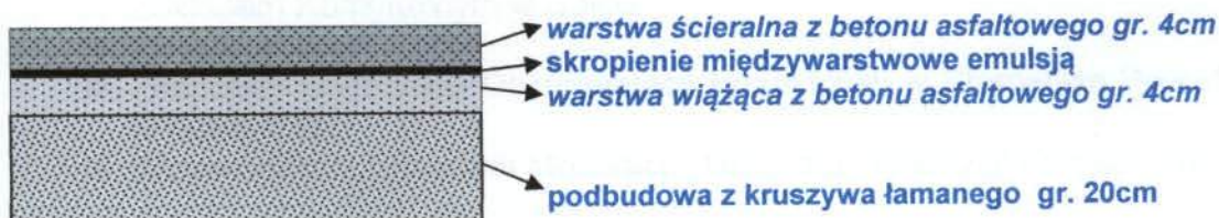
Rys. Konstrukcja drogi
